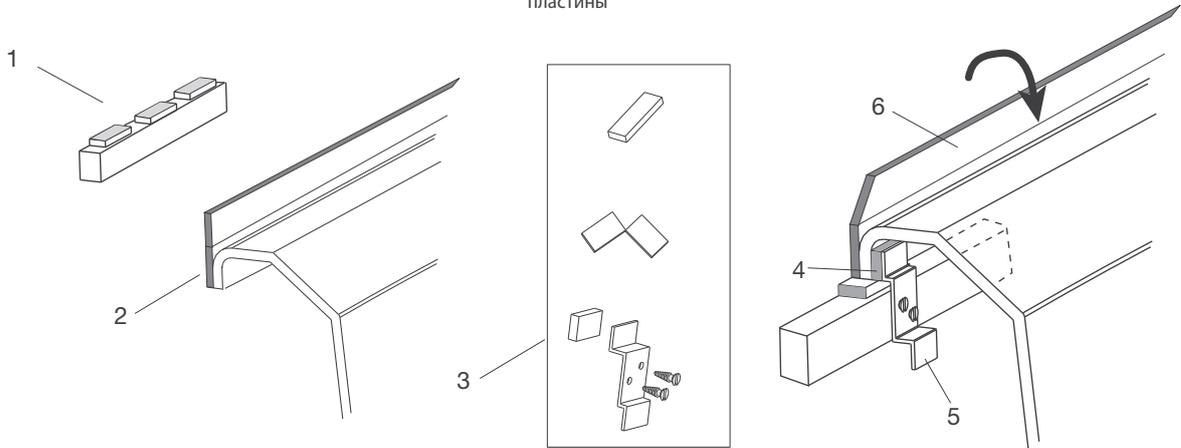
1. Распределите три прокладки по поддерживающей опоре, которая устанавливается по периметру ванны.
