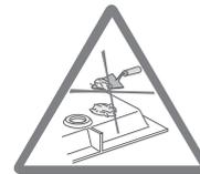
Запрещается непосредственный контакт между средствами с гидравлическим связующими, кроме стандартного строительного раствора, и изнаночной поверхностью поддона. Исключить блокировку по вертикали или сбоку.
