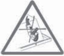
Ванна не должна подвергаться какому бы то ни было модификациям (резка, зачистка выступа, перемещение насоса...), за исключением просверливания отверстий для смесителей или ручек.
